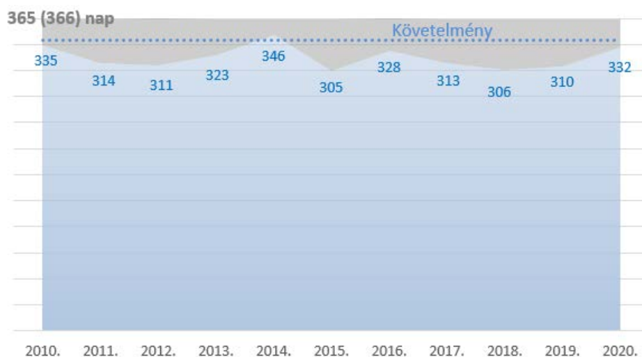
6. ábra: Az év tiszta napjainak (amelyik napon minden budapesti mérőállomás napi 8 órás mozgó átlagkoncentrációk maximuma alapján számított eredménye kisebb, mint 120 µg/m 3 ) aránya ózon (O 3 ) esetében (Adatforrás: OMSZ-LRK, saját számítás)
